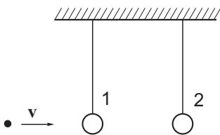
2. Пуля пробивает один из подвешенных грузиков и застревает в другом (см.рис.). Начальная скорость пули  $v$ , масса пули  $m$  равна массе каждого грузика. Найдите количество теплоты, выделившееся в первом грузике, если во втором выделилось количество теплоты  $Q$ .
