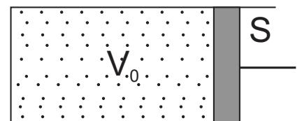
такой системе надавить или потянуть за поршень, то можно ощутить некоторые “упругие” силы. Покажите, что при малых деформациях для системы выполняется закон Гука и найдите жесткость системы при малых деформациях.
