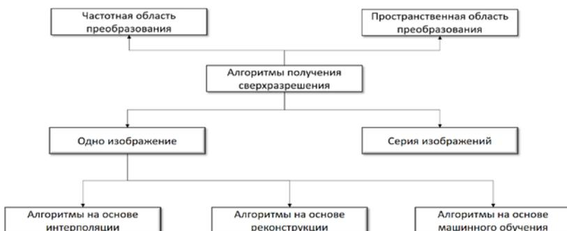
Рис. 1. Классификация алгоритмов получения сверхразрешения
