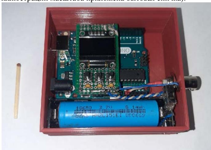
Рис. 3. Прототип цифрового осциллографа
