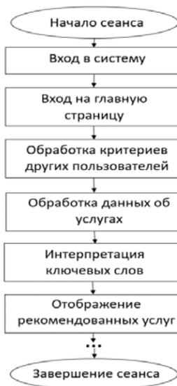
Рис. 1. Общий алгоритм работы системы
