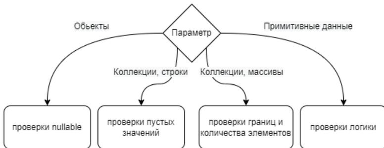
Рис. 6. Вариативность обработки параметров
