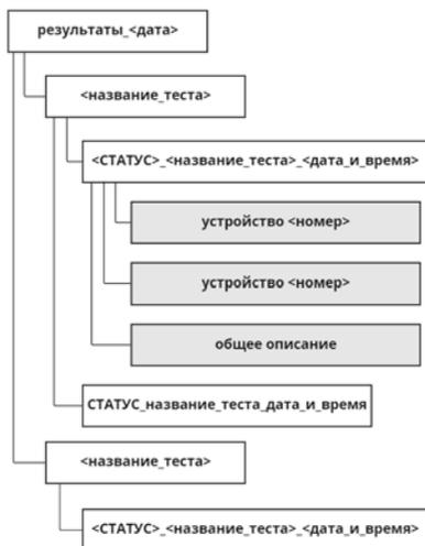
Рис. 3. Файловая структура для хранения лог-файлов при валидации
