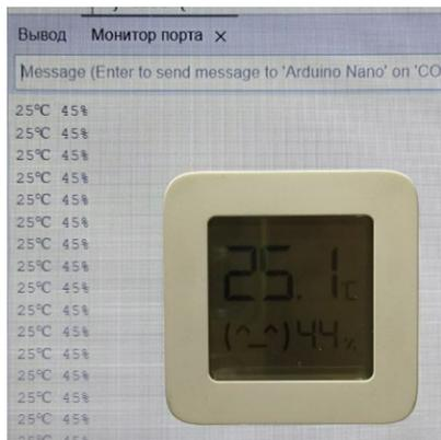
Рис. 6. Сравнение результатов измерений метеостанции и датчика DTH11
