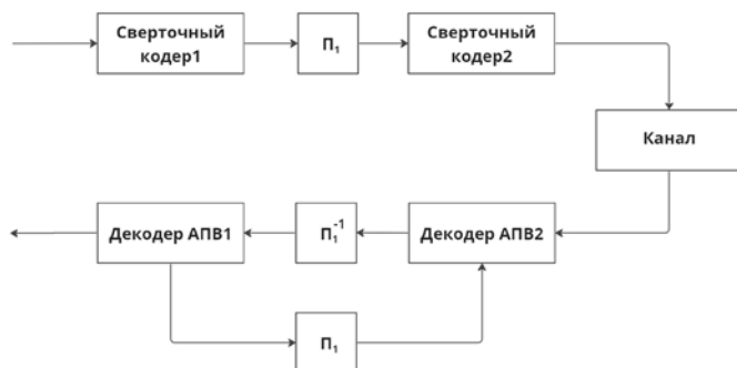
Рис. 2. Схема системы итеративного декодирования последовательно составного сверточного кода (SCCC)
