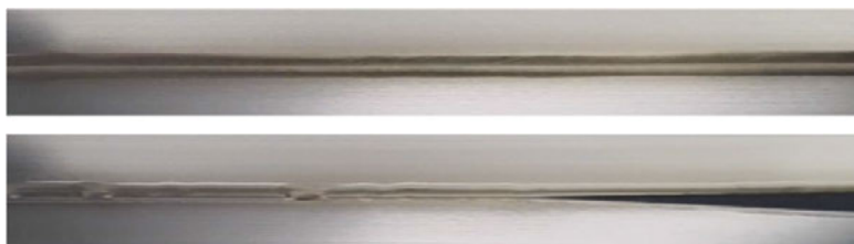
Рис. 2. Эталонное сварное соединение и соединение не соответствующее стандартам изделия
