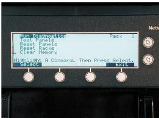
Рис. 6. ЖК-экран модуля управления системы iPatch.
