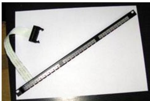
Рис. 3. Накладка превращает обычную коммутационную панель RiT в интеллектуальную.
