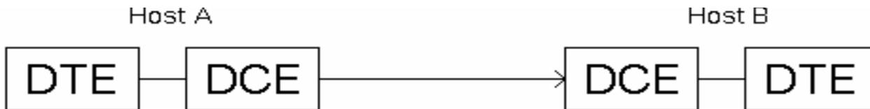
Передача и прием данных производится не одновременно, а последовательно
