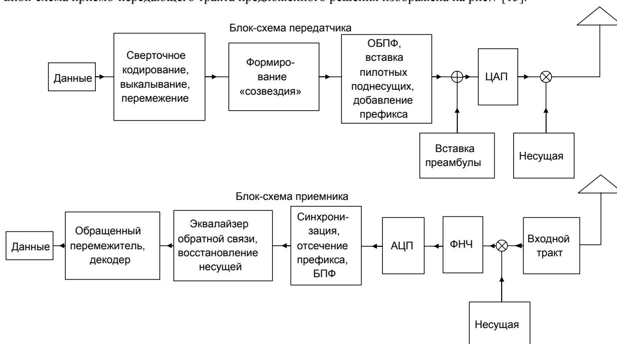
Рис.7. Блок-схема приема-передающего устройства многополосной UWB-системы на основе OFDM-подхода
