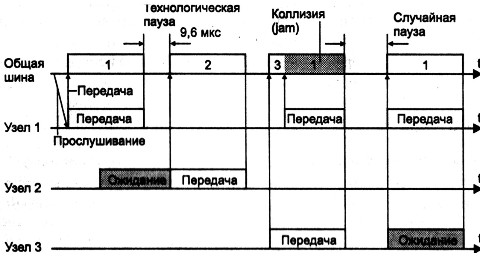
CSMA/CD - Carrier Sense Multiple Access with Collision Detection, протокол множественного доступа с прослушиванием несущей и обнаружением коллизий
