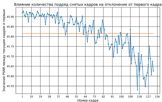
Рис. 4. Влияние количества подряд снятых кадров на отклонение от первого кадра (Sony A7C)
