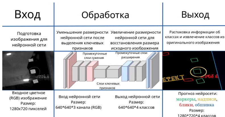
Рис. 1. Принцип обработки и распознавания изображений контрольных маркеров на поверхности остекления нейросетью
