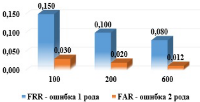
Рис. 3. Ошибки первого рода и ошибки второго рода при распознавании пользователей по изображению лица
