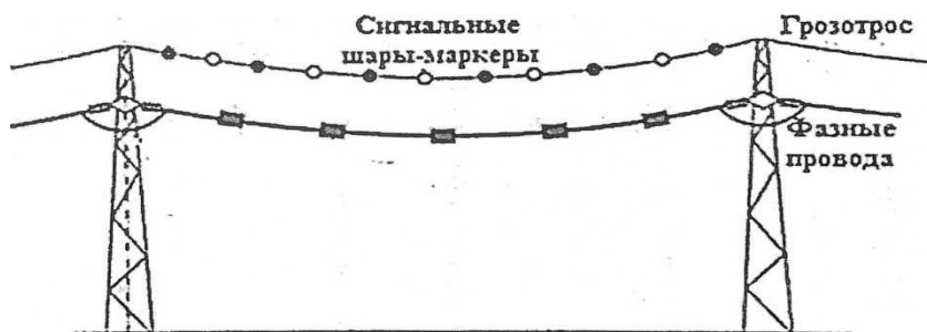
Рис. 2. Размещение сигнальных шаров-маркеров на проводах линий электропередач
