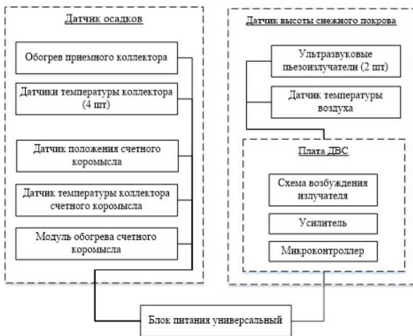
Рисунок. Структурная схема датчика осадков с датчиком высоты снежного покрова
